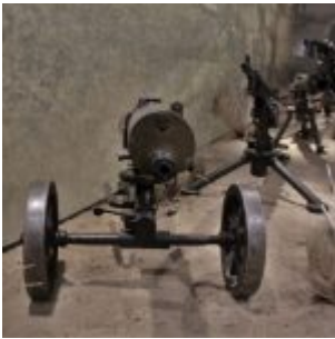
Russki ciężki karabin maszynowy Maxim nr. 1910 kal. 7,62 mm na podstawie kolowej Kolesnikowa Russian M1910 Maxim heavy machine gun, cal. 7.62 mm, on a wheeled Kolesnikov mount
