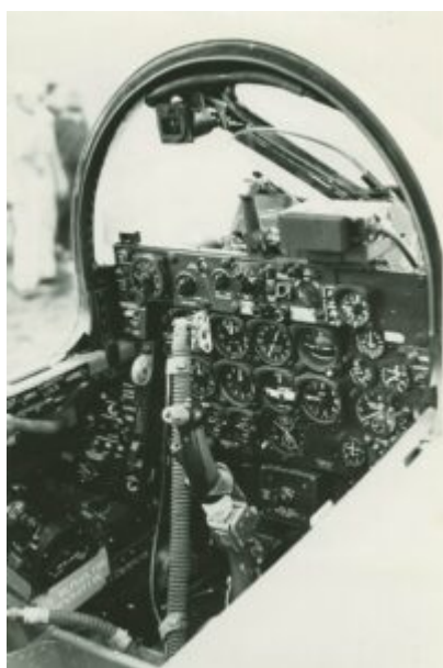
Tablica przyrządów w kokpicie samolotu F-84F
