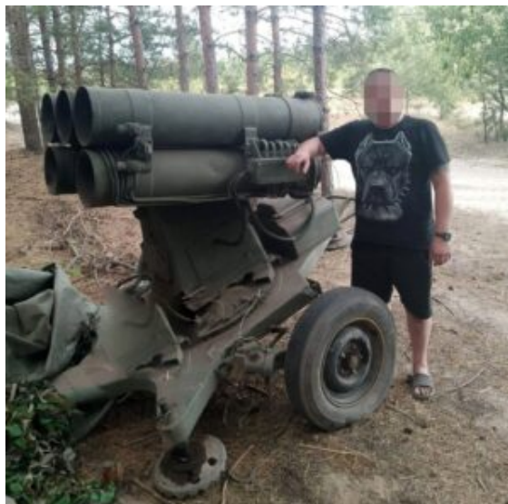
Ciekawostka, wyrzutnia zamontowana na platformie zestawu ZU-23-2
