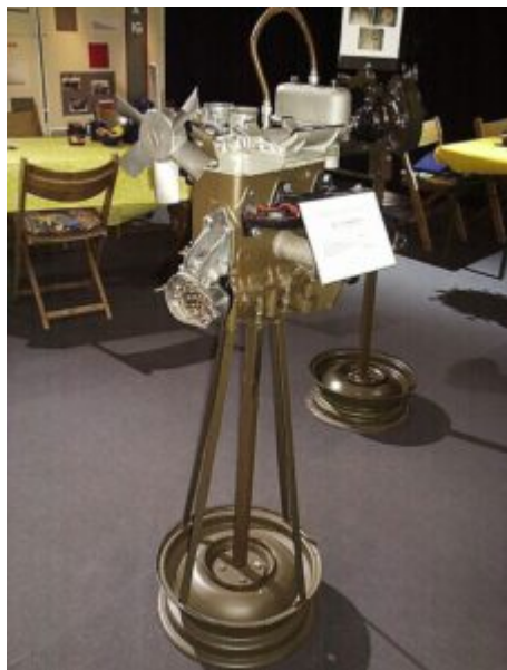
Model przekrojowy. Silnik DKW Munga 44 KM
