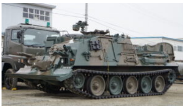
Wóz zabezpieczenia technicznego Typ-78
