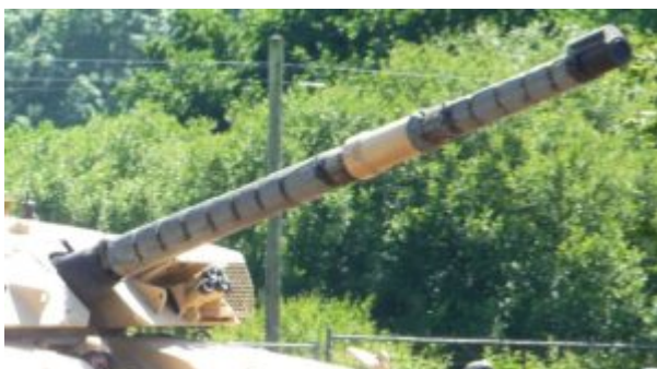
Armata czołgowa L11A5 kalibru 120 mm (długość L/55)
