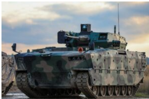
Prototyp BWP Borsuk z wieżą bezzałogową ZSSW-30 (2022 rok)
