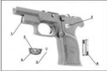
Fot. 6 Zmontowany szkielet pistoletu WIST 94L: 1 - moduł laserowy; 2 - włącznik celownika laserowego; 3 - ucho; 4 - zaśleпка z naktęką M3,5; 5 - sprężyna; 6 - bateria zasilająca
