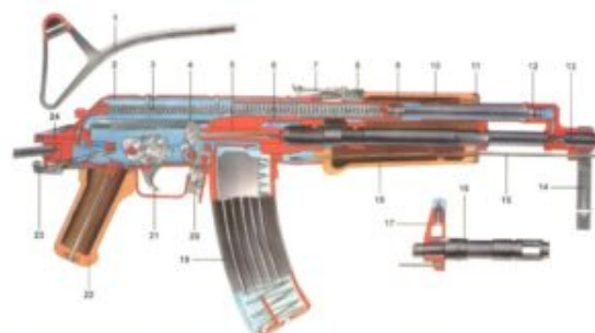
Przekrój 5,45 mm karabinka wz. 1988 Tantal (oprac.) 1 – kolba, 2 – pokrywa komory zamkowej, 3 – urządzenie powrotne, 4 – luzek, 5 – zamek, 6 – suwaczka, 7 – ramię celownika, 8 – podstawa celownika, 9 – rura gazowa, 10 – nakładka, 11 – obsada foto i nakładki, 12 – komora gazowa, 13 – lufa, 14 – dźwignia, 15 – wyciel, 16 – wielofunkcyjne urządzenie wycielowe, 17 – podstawa muszki z muszką, 18 – kolba, 19 – magazynek, 20 – zatrzask magazynka, 21 – język spustowy, 22 – chwyt pistoletowy, 23 – zatrzask kolby, 24 – jarzmo kolby (rys. J. Malejko)
