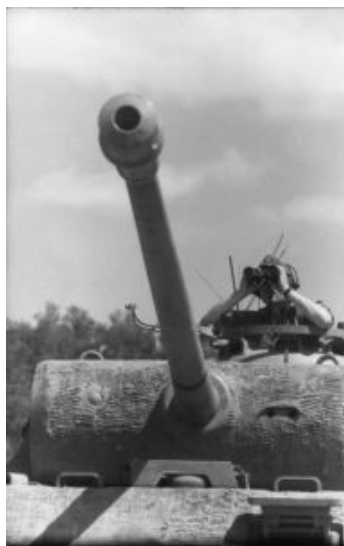
armata 7,5 cm KwK 42 L/70 kalibru 75 mm
