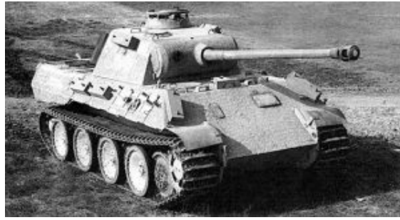
Czołg "Panther" Ausf D2 późniejszej serii produkcyjnej, wyposażony w nowy typ wieżyczki dowódcy.
