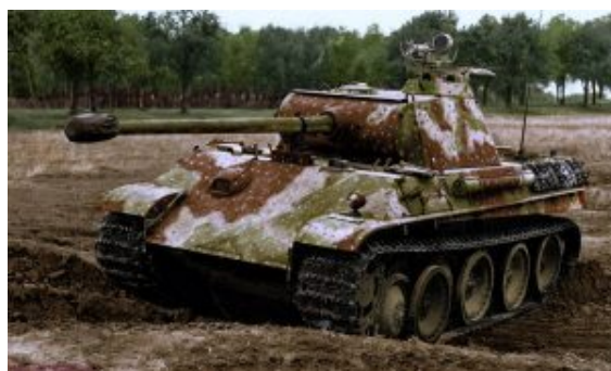
Czołg "Panther" Ausf.G wyposażony w noktowizor
