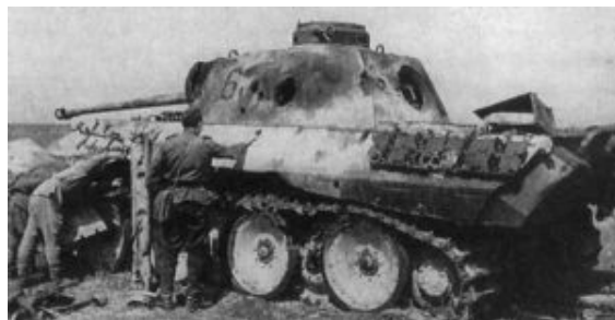
Czołg "Panther" Ausf D2 z 6.Kompanii 52.Batalionu Pancernego zniszczona trafieniami pocisków kalibru 45 i 76mm w pancierz boczny, operacja Zitadelle lipiec 1943 roku.
