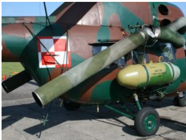
Śmigłowiec Mi-2 Ch „Chekla”. Widoczna instalacja dymotwórcza. Rok 2008
