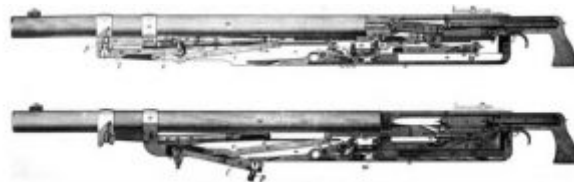
Przekroje z różnymi położeniami tłoka gazowego
