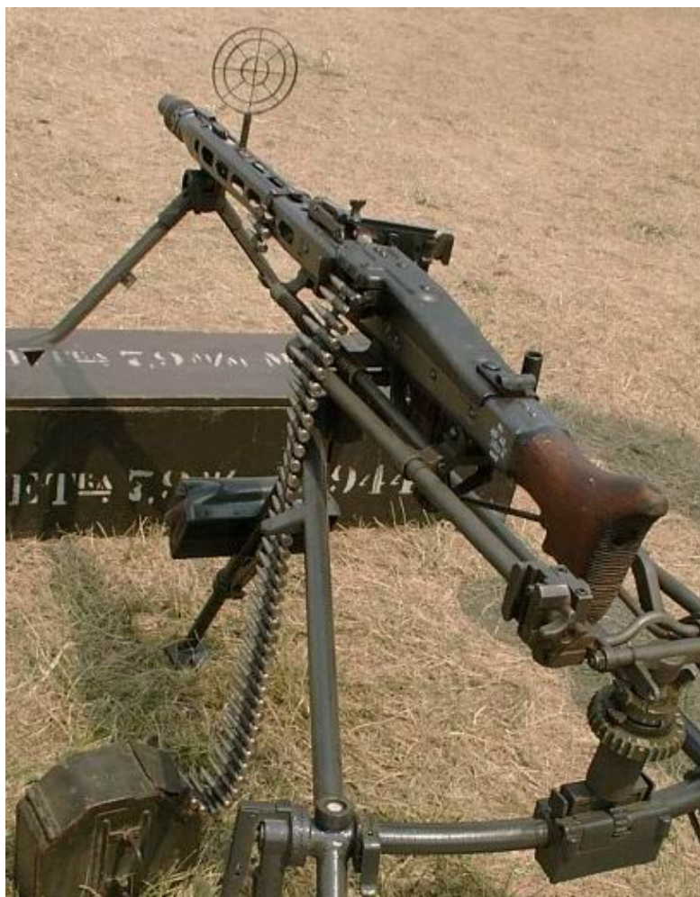
MG 42 zamontowany podstawie trójnożnej Lafette 42 oraz wyposażony w muszkę rekursową przeznaczoną do strzelań przeciwlotniczych.
