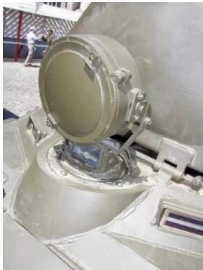
Peryskop dowódcy TKN-3 i reflektor podczerwieni OU-5-1 IR
