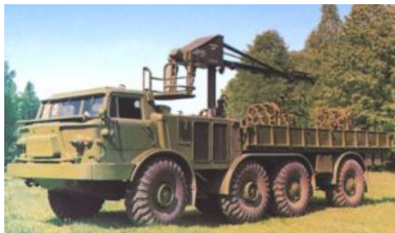
9T452 – pojazd transportowo-załadowniczy
