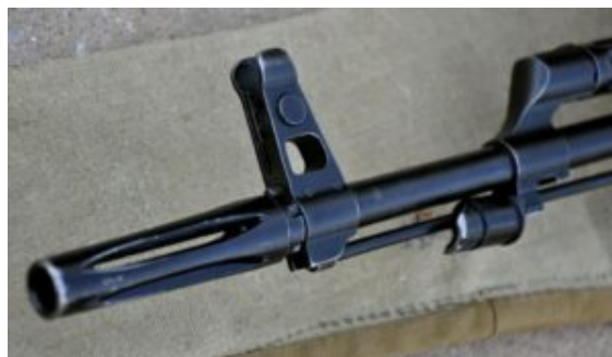
Szczelinowy tłumik płomieni wylotowych (zbliżony do PK)
