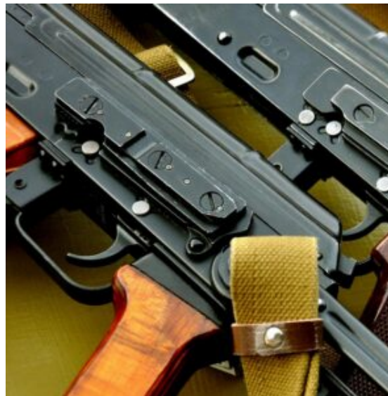
Szyna montażowa AKMSŁ, lewe ramię kolby miało specjalne podcięcie by dało się ją złożyć
