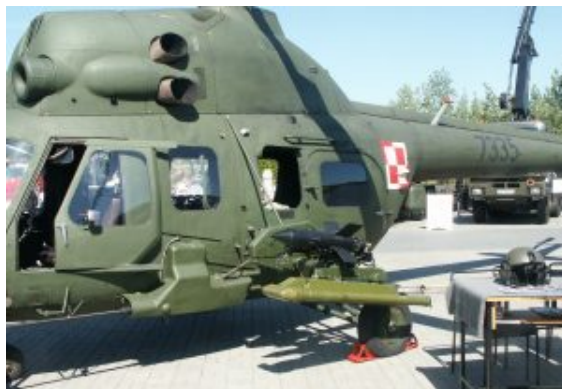
W cztery wyrzutnie rakiet ppanc 9M14 "Malutka" uzbrojona była wersja bojowa śmigłowca PZL Mi-2URP. Fot. Pibwł
