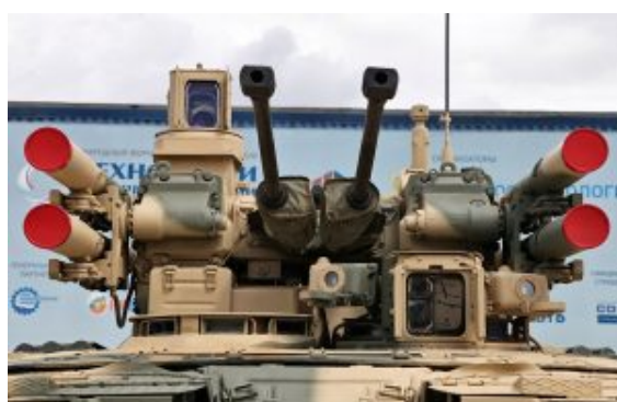
Cztery wyrzutnie 9M120 Ataka zamontowane na BMPT Terminator. Fot. Vitaly Kuzmin
