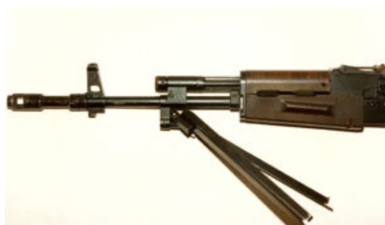
Widok na regulator gazowy i integralny bipod
